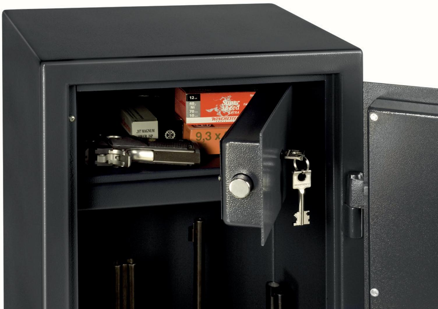
Namijenjeni su čuvanju pištolja, pušaka i municije. Ormari su proizvedeni od hladnovaljanog lima. Konstrukcija je u potpunosti varena te kao takva čini ormar čvrstim. Površine ormara su plastificirane sivom bojom RAL 7032 ili bojom po zahtjevu kupca. Sigurnosna brava sa trosmjernim mehanizmom zatvaranja i dva ključa
